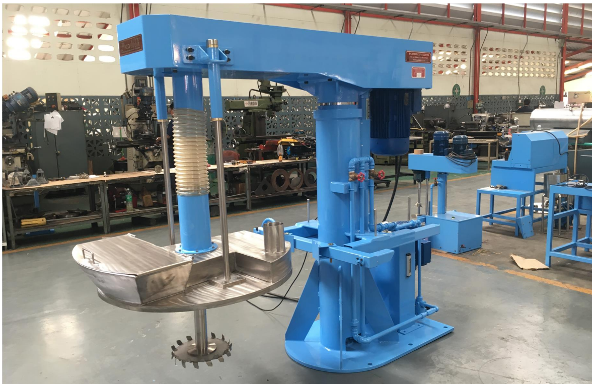
5. ชุดฝาครอบถังบดสารเคมี (Chemical crusher cover set with chemical inlet)
