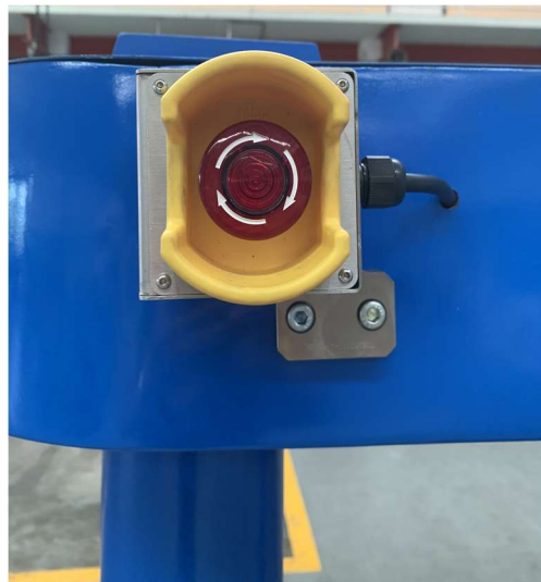
9. สวิทช์ฉุกเฉินภายนอก (External Emergency Switch)
